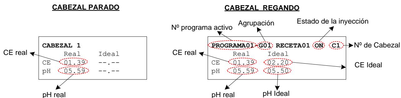
Si deseamos ver el estado de la inyección en otros cabezales, iremos pasando de uno a otro pulsando las teclas **↑** y **↓**.
