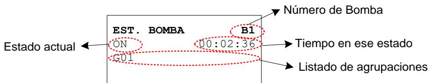
Se accede desde la pantalla de Estado de Válvulas pulsando la tecla →. Esta pantalla muestra el estado de las bombas de riego
