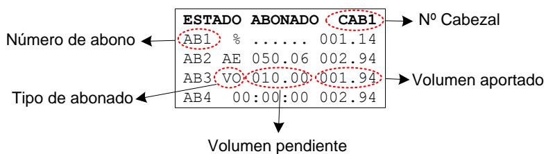
Se accede desde la pantalla de Estado de Drenaje en el Día de Hoy pulsando la tecla →. En esta pantalla se muestra el estado del abonado de cada uno de los cabezales de riego.
