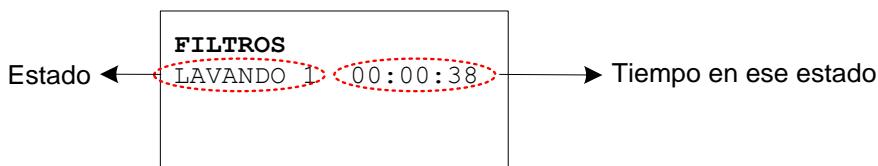
Se accede desde la pantalla de Estado del Abonado pulsando la tecla →. En esta pantalla se muestra el estado en el que se encuentra el sistema de filtrado.
